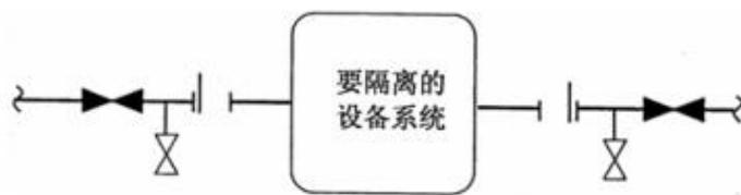
图 C.5 管线拆卸隔离
