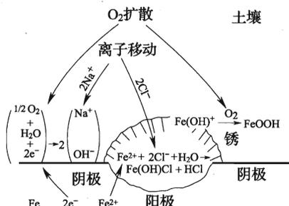
图 1 氧浓差电池的腐蚀模型
